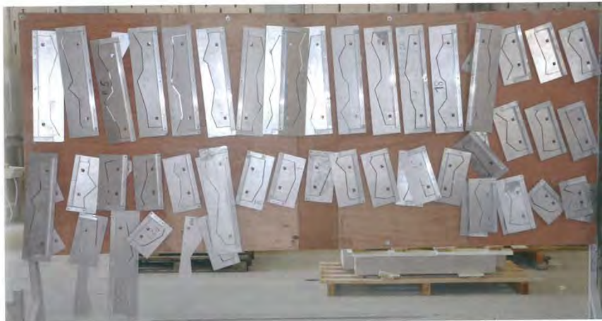
Vues des profils de moule destinés aux façades du Centre Spirituel et Culturel Russe à Paris. Tyrolit a réalisé une vingtaine de meules spéciales pour ces usinages. Ceux-ci ont été réalisés en une passe, jusqu'à 50 mm de matière enlevés, avec un degré de précision et une qualité de finition remarquables. Un seul outil par profil a été nécessaire pour réaliser la totalité des façonnages.
